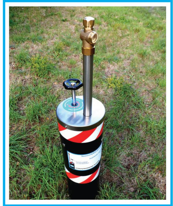
Der KEBI - Bauwasseranschluss wird mit einem Innengewinde 3/4" geliefert und kann jederzeit mit einem Wasserzähler oder Systemtrenner ausgerüstet werden. Mit dem Handrad lässt sich die Erdabsperrrarmatur einfach schließen und die Steigleitung entleert automatisch. Anschlussgewinde im Erdreich 1 1/4" IG.
