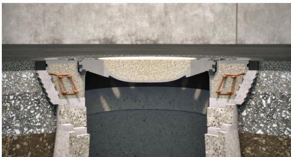
Der breite und konische Rahmen der Schachtabdeckung hat eine erheblich vergrößerte Lastabtragsfläche, da die Last auch seitlich abgeleitet wird. Das führt zu einem sehr geringen Auflagen- druck und es wird eine besonders gute Verkrallung von Schachtabdeckung und Straße geschaffen und der optimale Lastabtrag wird dauerhaft sichergestellt.
