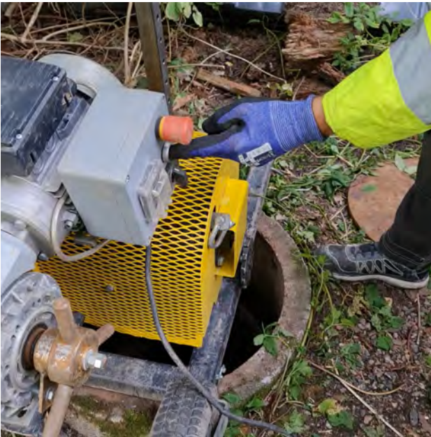
4d) Seilwinde mit Verlängerungsstange
