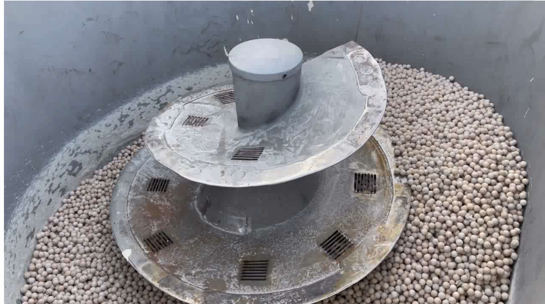
Bild B) 20% Schüttung – Mischschnecke im Trockner
